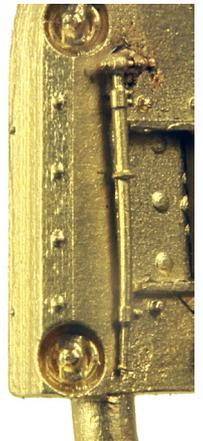
Zapfen der Hebelmechanik (T25) unten auf 1mm kürzen und an den Wasserstand- anzeiger löten. Wasserstands- anzeiger mit der Mechanik anlöten.
